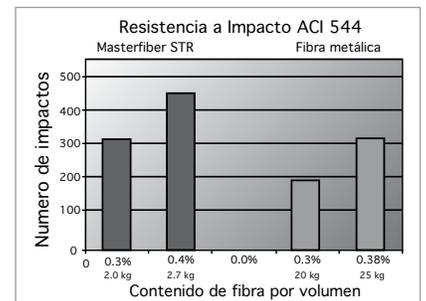
\* La fibra metálica utilizada para todas las pruebas comparativas es fibra de acero al carbón con terminación de gancho de 57.2 x 0.8 x 0.8 mm.
